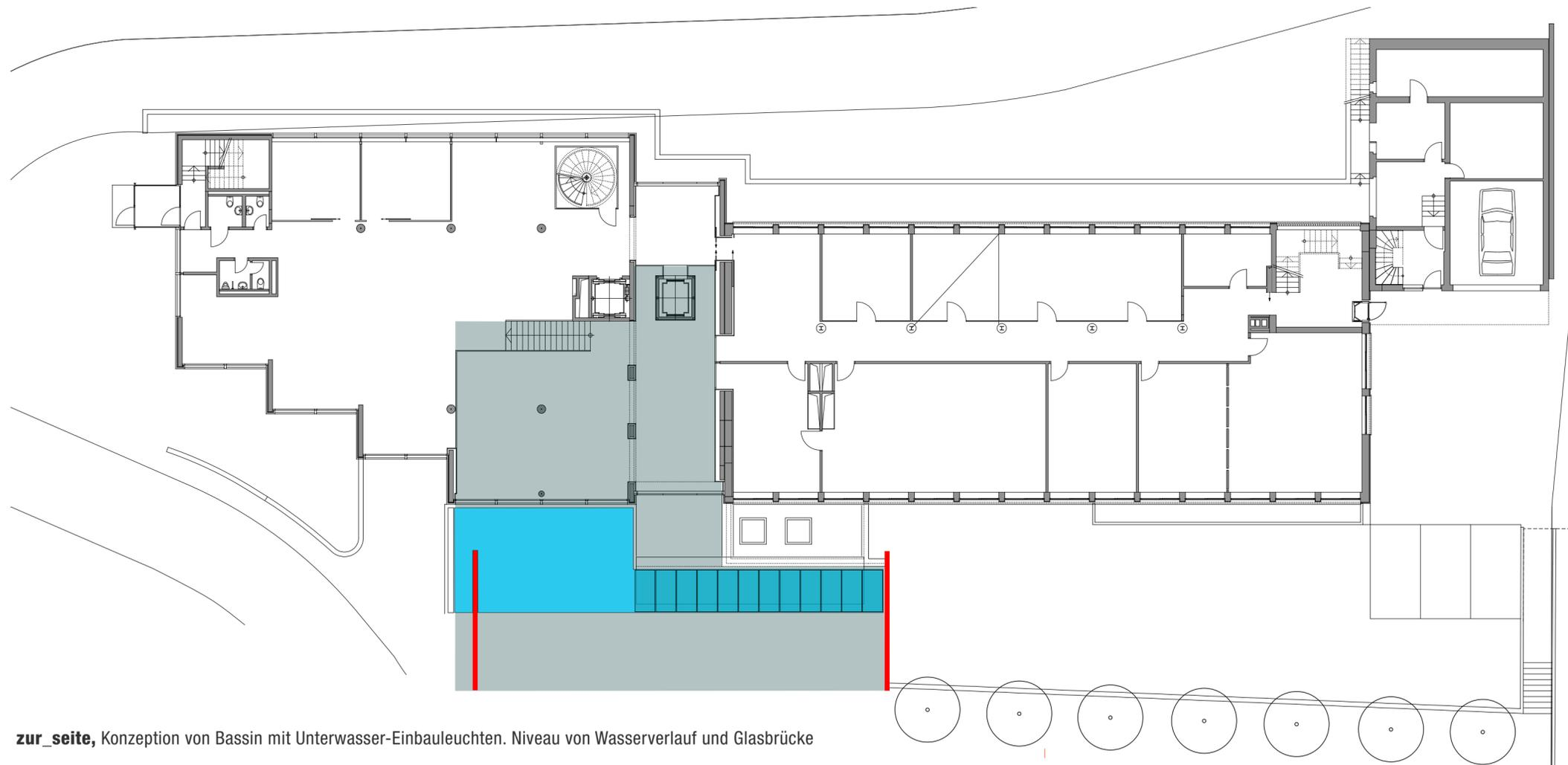
zur\_seite, Konzeption von Bassin mit Unterwasser-Einbauleuchten. Niveau von Wasserverlauf und Glasbrücke
